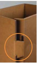
Dans le cas de l'assise, les renforts (pièces n°2) s'assemblent en croisillon et s'intègrent dans le cube intérieur.
